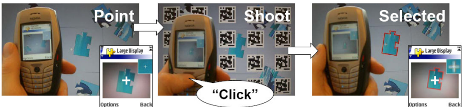
Abbildung 4. Point&Shoot: (Links) Das Objekt wird mit Hilfe des Telefondisplays anvisiert. (Mitte) Der Joystick wird gedrückt, die visuellen Codes erscheinen für kurze Zeit. (Rechts) Das Objekt wurde erfolgreich ausgewählt. [10]
