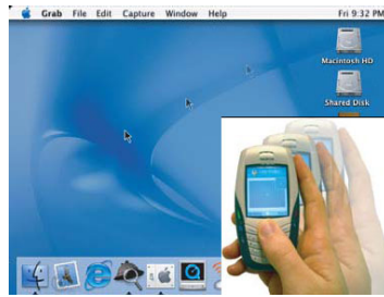
Abbildung 3. Sweep-Technik: Die Bewegungen des Mobiltelefons werden auf den Cursor des großen Displays übertragen. [10]
