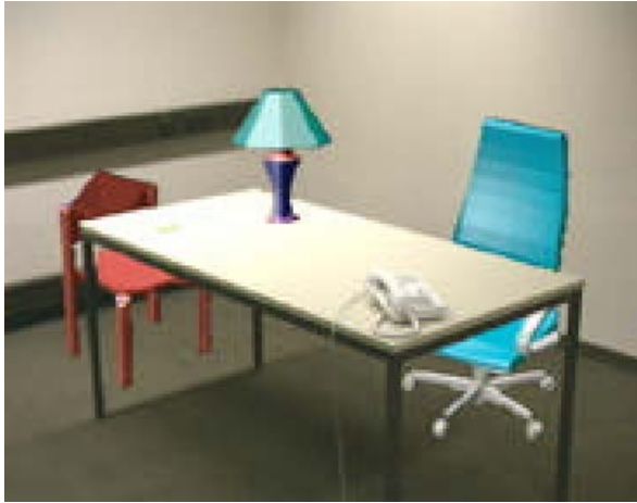
Abbildung 2: Realer Tisch mit virtueller Lampe und zwei virtuellen Stühlen. Lampe und Stühle werden korrekt im dreidimensionalen Raum gezeichnet (Verdeckung der Stühle durch den Tisch und Verdeckung des Tisches durch die Lampe) [9].
