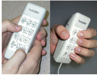
Abbildung 2. Twiddler. Links wird der Twiddler wie Tastatur eines Mobiltelefons verwendet. Rechts - als die Texteingabetechnik basiert auf dem gleichzeitigen Drücken mehrerer Tasten[5].
