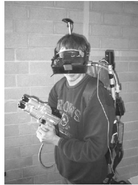
Abbildung 14: Geräte von ARQuake. Ein tragbarer Computer auf dem Rücken (links), sowie das HMD und die „echte“ Pistole (rechts) [13]
