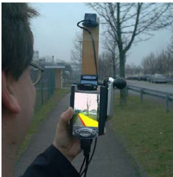
Abbildung 9: Visualisierung von INSTAR auf einem PDA für freie Navigation zu Fuß (links), oder im fest installiert im Auto (rechts) [8]
