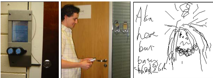
Abbildung 12. (Links) Ein frühes Modell des Hermes Office Displays. (Mitte) Interaktion mit dem Office Display über ein Mobiltelefon. (Rechts) Die hinterlassene Nachricht. [18]
