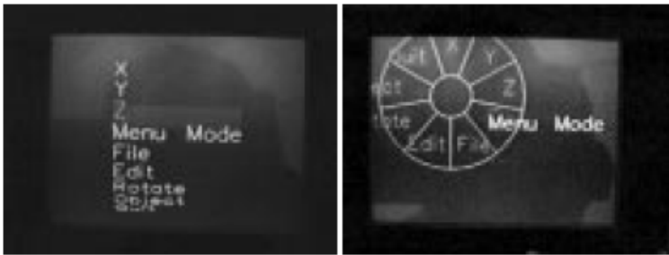
Abbildung 13. Menu-Navigation durch Neigungserkennung. Links ist ein zylindrisches und rechts ein tortenförmiges Menu dargestellt[1].
