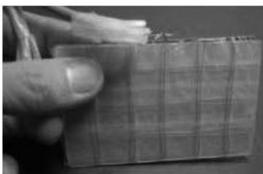
Abbildung 10. links: Prototyp GesturePad mit seinen Gittersensoren zur Kapazitätsmessung - rechts: Variation B des GesturePad, welche in Zusammenhang mit GestureWrist verwendet wurde. [15]
