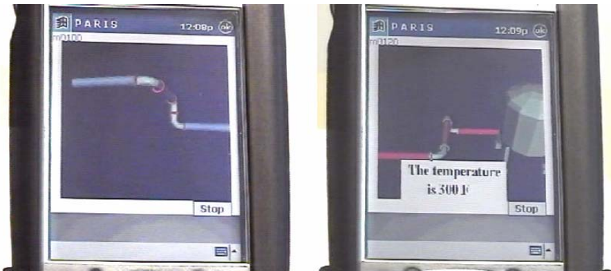
Abbildung 11: Visualisierung des PARIS-Systems: 3D Ansicht eines Rohrs mit den Verbindungen in rot (links), Ansicht zweier Rohre in rot markiert mit einem Dialog für die Temperatur (rechts) [6]
