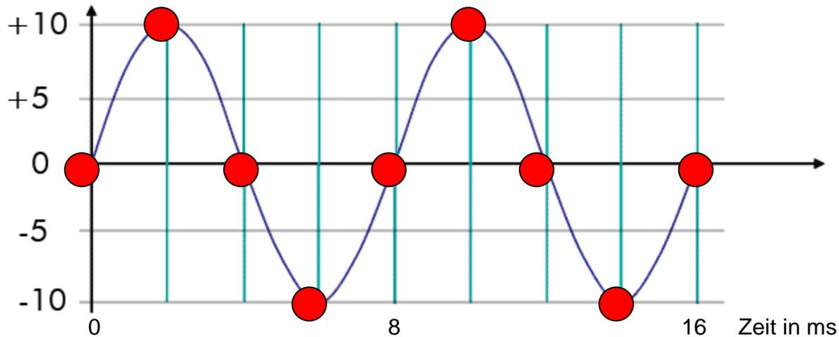
Messungen mit 0,5 kHz = 500 Hz
