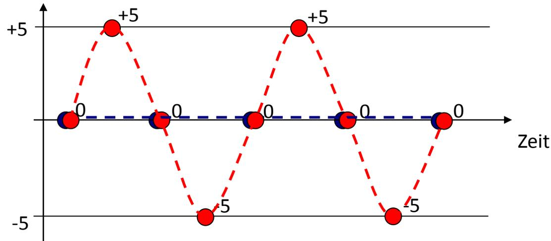
Aus den Samples wird versucht, das Originalsignal zu rekonstruieren. Je höher die Abtastrate desto besser die Rekonstruktion.
