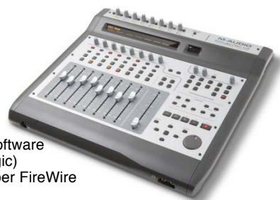
Digitales Mischpult mit eigenem DSP (Digital Sound Processor)
